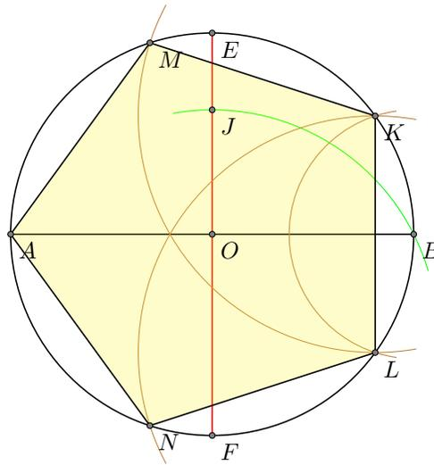
Ci-contre, un schéma illustrant toutes les étapes nécessaire pour dessiner un pentagone régulier à l'aide d'une règle non-gradué et d'un compas.
