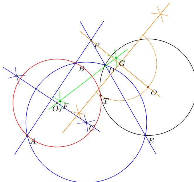
**Construction 5.1.9. (PCC)** À l'aide d'une règle et d'un compas, dessiner un cercle tangent à deux cercles donnés et passant par un point donné.
