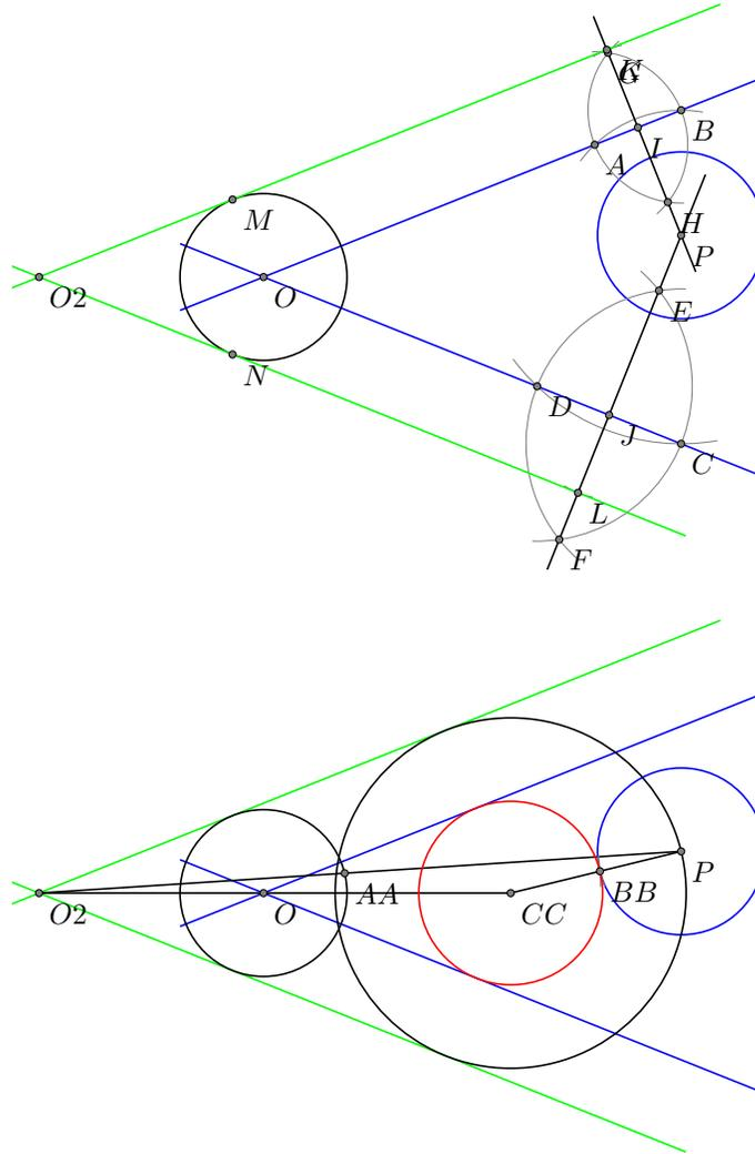
**Construction 5.1.6. (PDC)** À l'aide d'une règle et d'un compas, dessiner un cercle passant par un point, et tangent à une droite et un cercle donnés.
