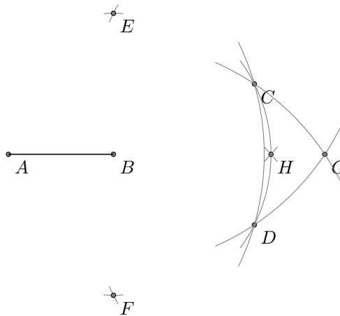
**Construction 5.4.2.** Si des segments de longueurs  $a$ ,  $b$  et  $c$  respectivement nous sont donnés, alors la construction ci-dessous nous permet de trouver un segment de longueur  $x$  où  $\frac{x}{c} = \frac{a}{b}$ .
