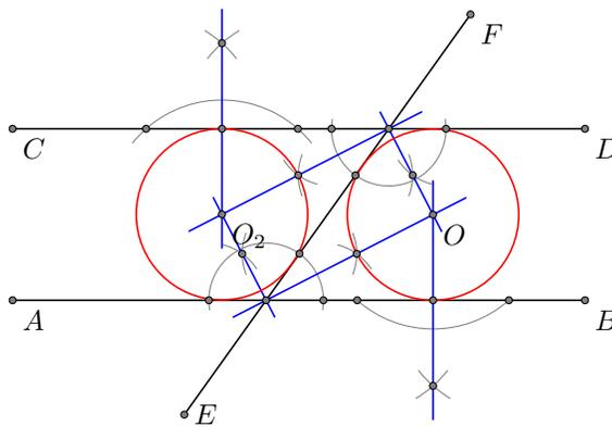
**Construction 5.1.3. (PDD)** À l'aide d'une règle et d'un compas, dessiner un cercle passant par un point et tangent à deux droites.
