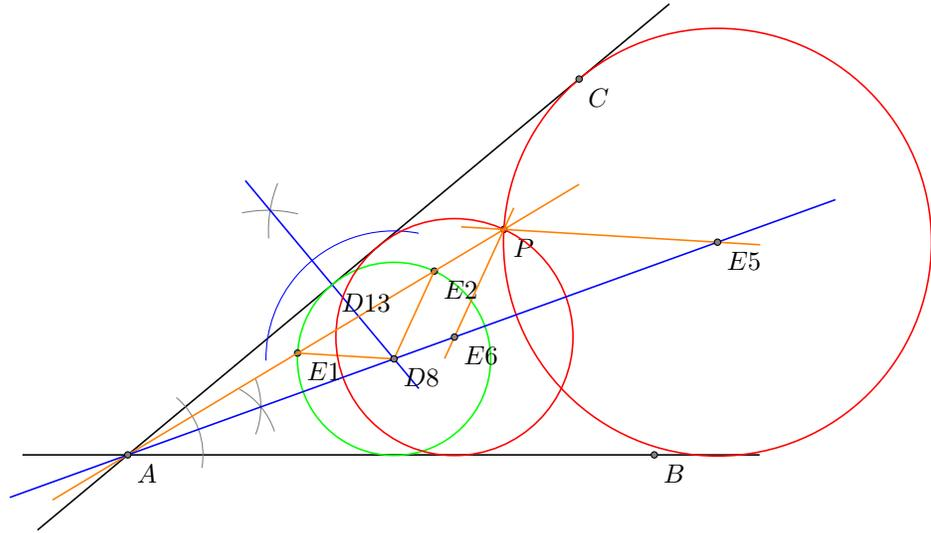
**Construction 5.1.4. (PPD)** À l'aide d'une règle et d'un compas, dessiner un cercle passant par deux points et tangent à une droite.
