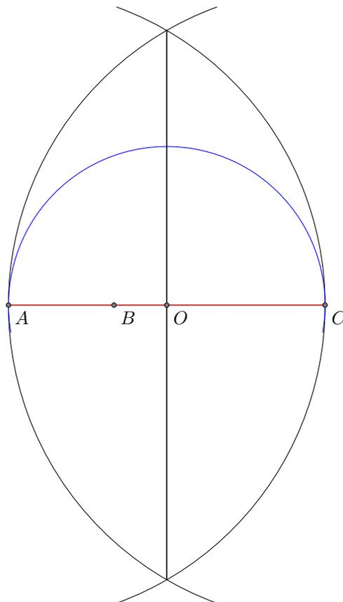
**Étape 3 :** On dessine maintenant une droite perpendiculaire à  $AC$  et qui passe par le point  $B$ . On dénote le point d'intersection de cette droite avec le cercle que nous avons trouvé à l'étape précédente par la lettre  $D$ .
