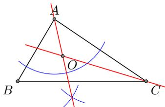
**Étape 2 :** Utilisez la construction qui permet de couper un angle en deux pour dessiner la bissectrice de l'angle BAC
