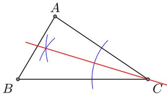
**Étape 1 :** Utilisez la construction qui permet de couper un angle en deux pour dessiner la bissectrice de l'angle ACB
